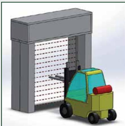
Das ALIGA-EST verfügt im Standard über zwei Sicherheitssysteme. Die Schließkantenabsicherung funktioniert über eine  $8,2\text{ k}\Omega$  Sicherheitskontaktleiste, welche in der Bodenabschlußleiste integriert ist (gemäß ASR 1.7). Zusätzlich verfügt das ALIGA-EST über 4 Sicherheitslichtschranken um die Gefahr möglicher Kollisionen zu minimieren und ein kontaktloses Reversieren des Tores zu ermöglichen.
